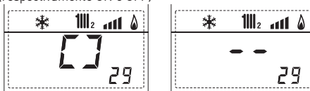
30. Visualização valor da temperatura da sonda solar S1 com placa ZONA MIX 2
